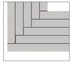
FIGURE 10 OPTION 3: STAGGERED 45° CORNER JOINT
