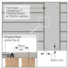
FIGURE 7 OPTION 3: BREAKER BOARD JOINTS
