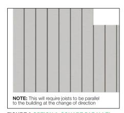
FIGURE 9 OPTION 2: SQUARE PARALLEL CORNER JOINT
